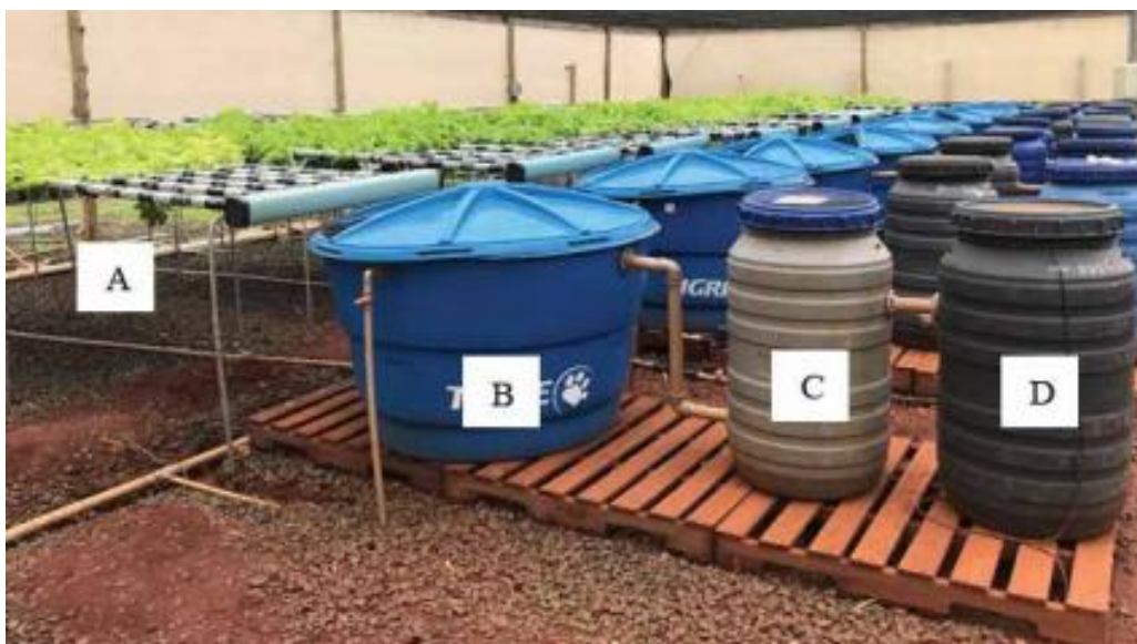
Figura 1. O sistema aquapônico. Em (A), os perfis, em (B), o reservatório, em (C), o decantador e em (D), o filtro biológico.
